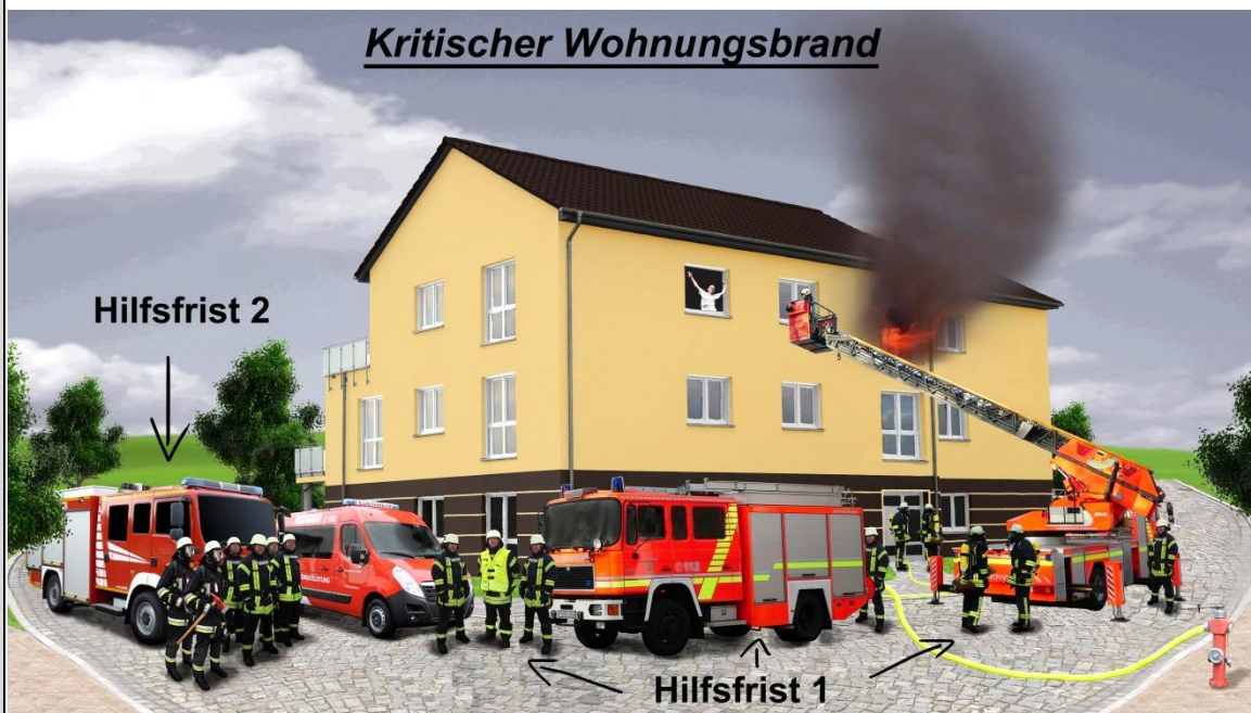
Rettung von Personen mit Hubrettungsgerät aus Gebäuden mit einer Höhe auch über 7m (gem. Punkt 3.1).
